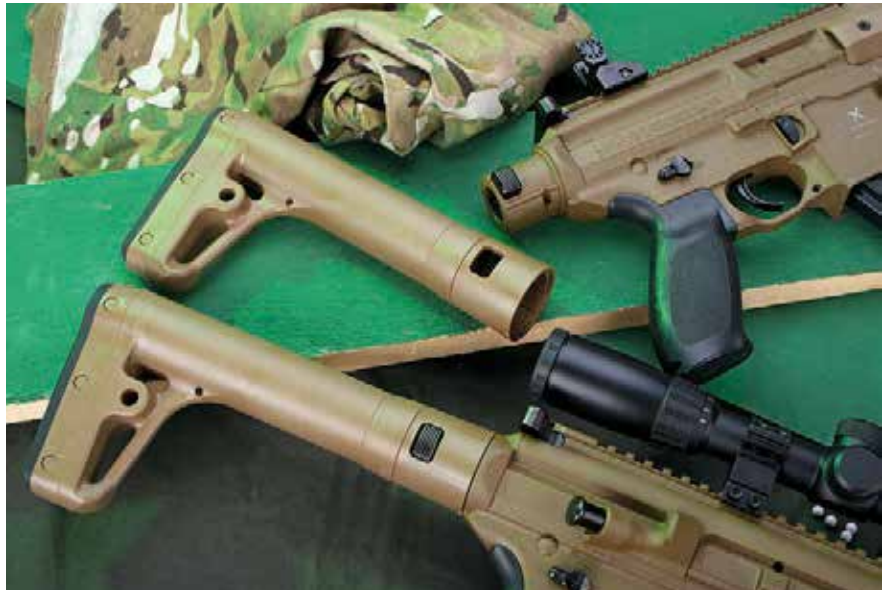
Im Schaft findet sich die 90-Gramm-Gaskartusche, die für den Antrieb sorgt. Die Montage gestaltet sich dabei denkbar einfach.
